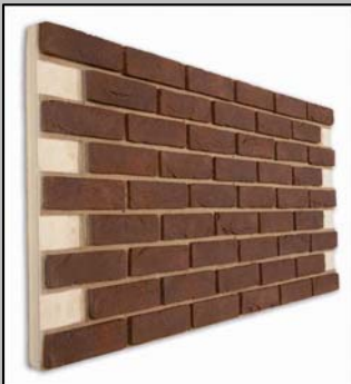
Voorbeeld van afwerking bijkomende scheidsmuurdelen door gebruik van steenstrips op isolatieplaten als alternatief voor paramentafwerking staand op aanpalende perceel
